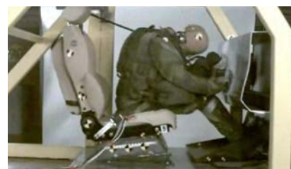
En crash-test demonstrerer risikoen for alvorlige skader med at bruge sikkerhedssele, når man kører med fuld udrustning og hjelm
